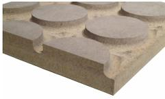
**BetonRadiant** Beton Radiant è un sistema modulare per la realizzazione di pavimenti radianti ed è costituito da due pannelli in cemento-legno, ad alta densità (1350 Kg/m<sup>3</sup>) come da normativa europea EN 13986.
