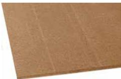
**FiberTherm Base** Il pannello in fibra di legno FiberTherm Base è un isolamento termico rigido e completamente ecologico ideale per la realizzazione di massetti a secco e ad umido, e solai calpestabili grazie alla sua elevata resistenza a compressione (150 kPa), alla sua densità pari a 250 kg/m<sup>3</sup>, ed alle sue proprietà di isolamento acustico anticalpestio.
